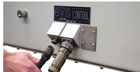
控制驱动的方案：用于 LEA 电压传感器的 8 针快速断开连接器，以及带集成静线操作控制的 19 针连接器。
