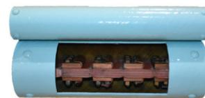
Primer plano del conductor principal seccionado y el fusible limitador de corriente de un CLiP de 3000A después de la interrupción
